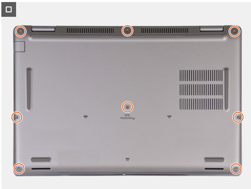
Obrázok 18. Utiiahnutie skrutiek s roznitovaným koncom
