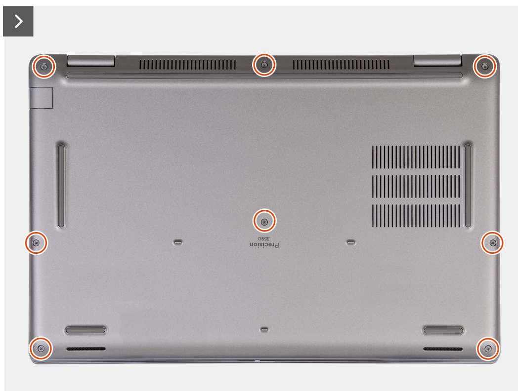
Obrázok 13. Uvoľnite skrutky s rozširovaným koncom
