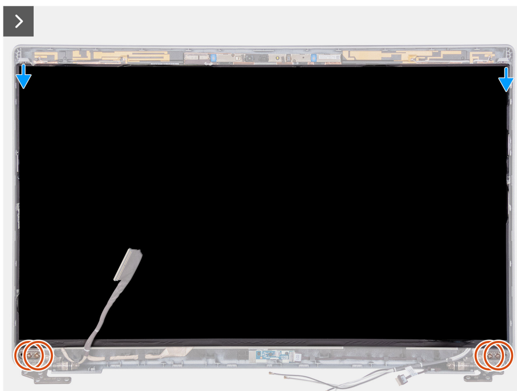
Obrázok 76. Demontáž zobrazovacieho panela
