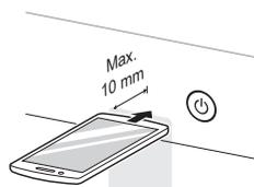
**3** Alespoň na tři sekundy držte tlačítko **Teplota** a zároveň držte mikrofon chytrého telefonu u tlačítka **Napájení**, dokud nedojde k přenosu všech dat.
