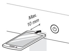
**3** Po dobu 3 sekúnd alebo dlhšie stlačte a podržte tlačidlo **Teplota** a zároveň držte náustok smartfónu pri tlačidle **Napájanie**, kým sa prenos údajov neskončí.
