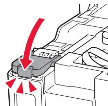
**9** A 2–8. lépéseket megismételve öntse bele az összes tintát a jobb oldalon található megfelelő tintatartályokba.
