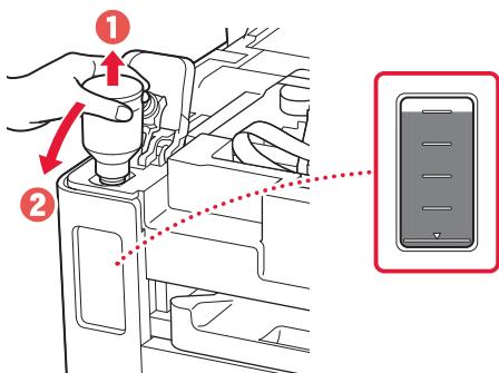
**7** Așezați la loc **în siguranță** capacul rezervorului.
