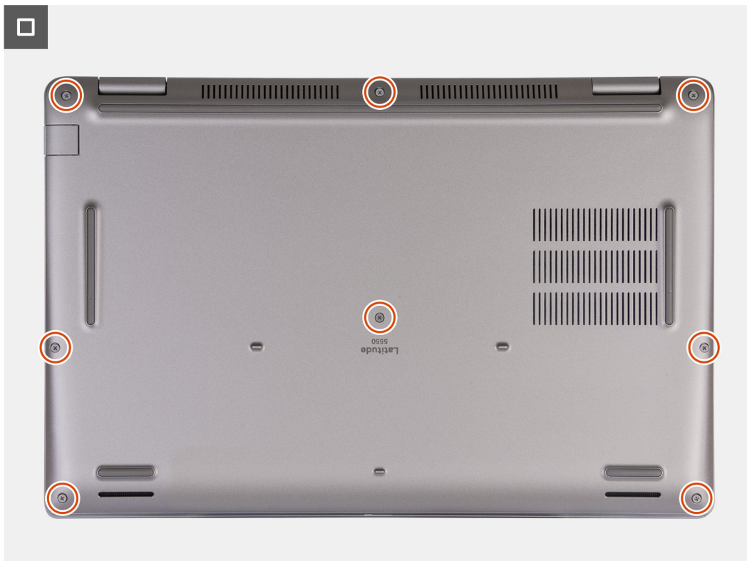
Obrázok 18. Uťahnutie skrutiek s roznitovaným koncom
