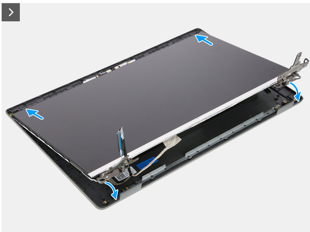
Obrázok 61. Montáž zobrazovacieho panela
