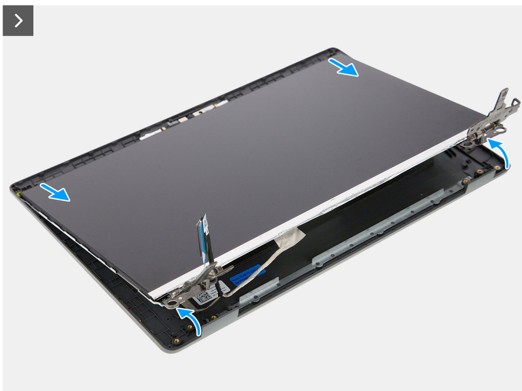
Obrázok 56. Demontáž zobrazovacieho panela
