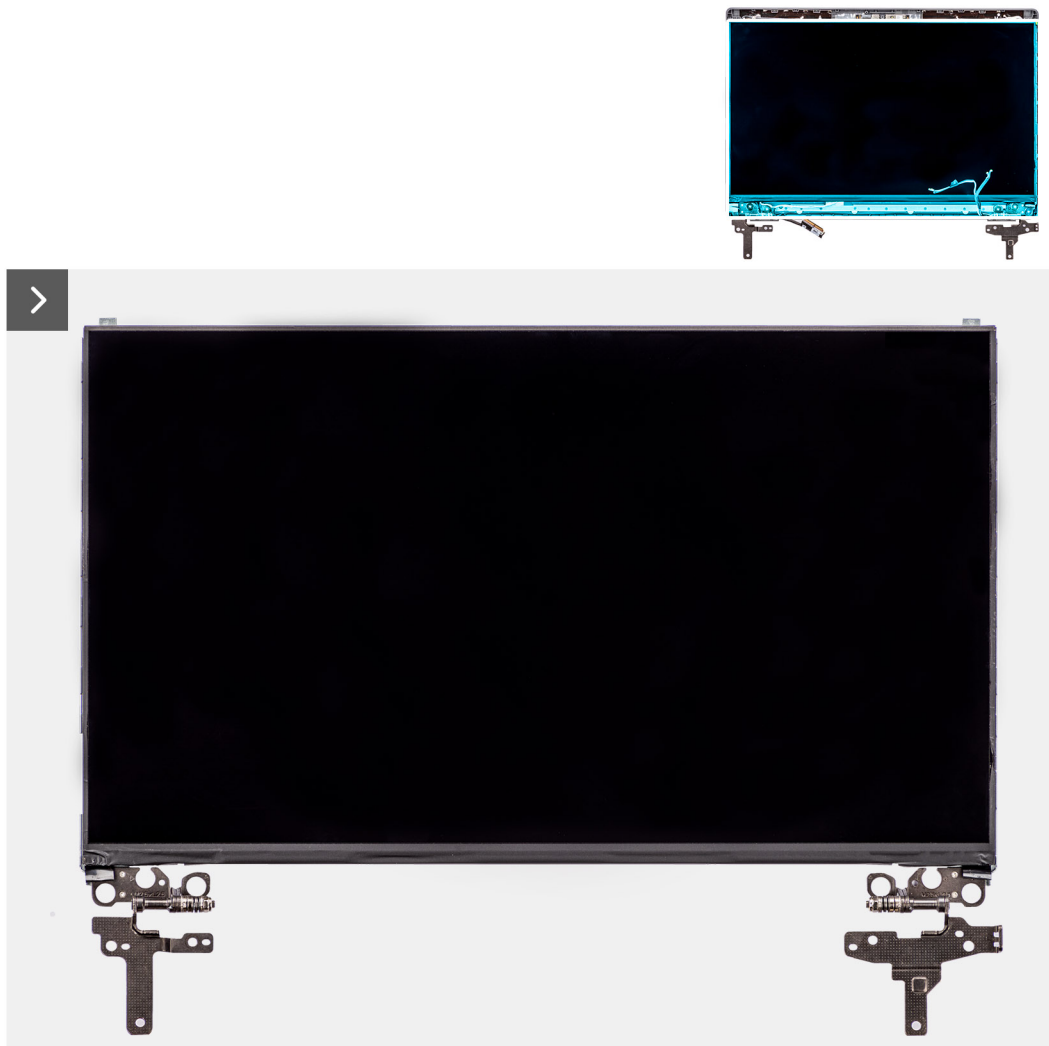
Obrázok 59. Montáž zobrazovacieho panela
