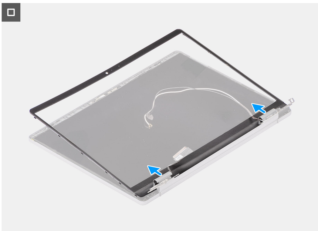
Obrázok 49. Demontáž rámu obrazovky
