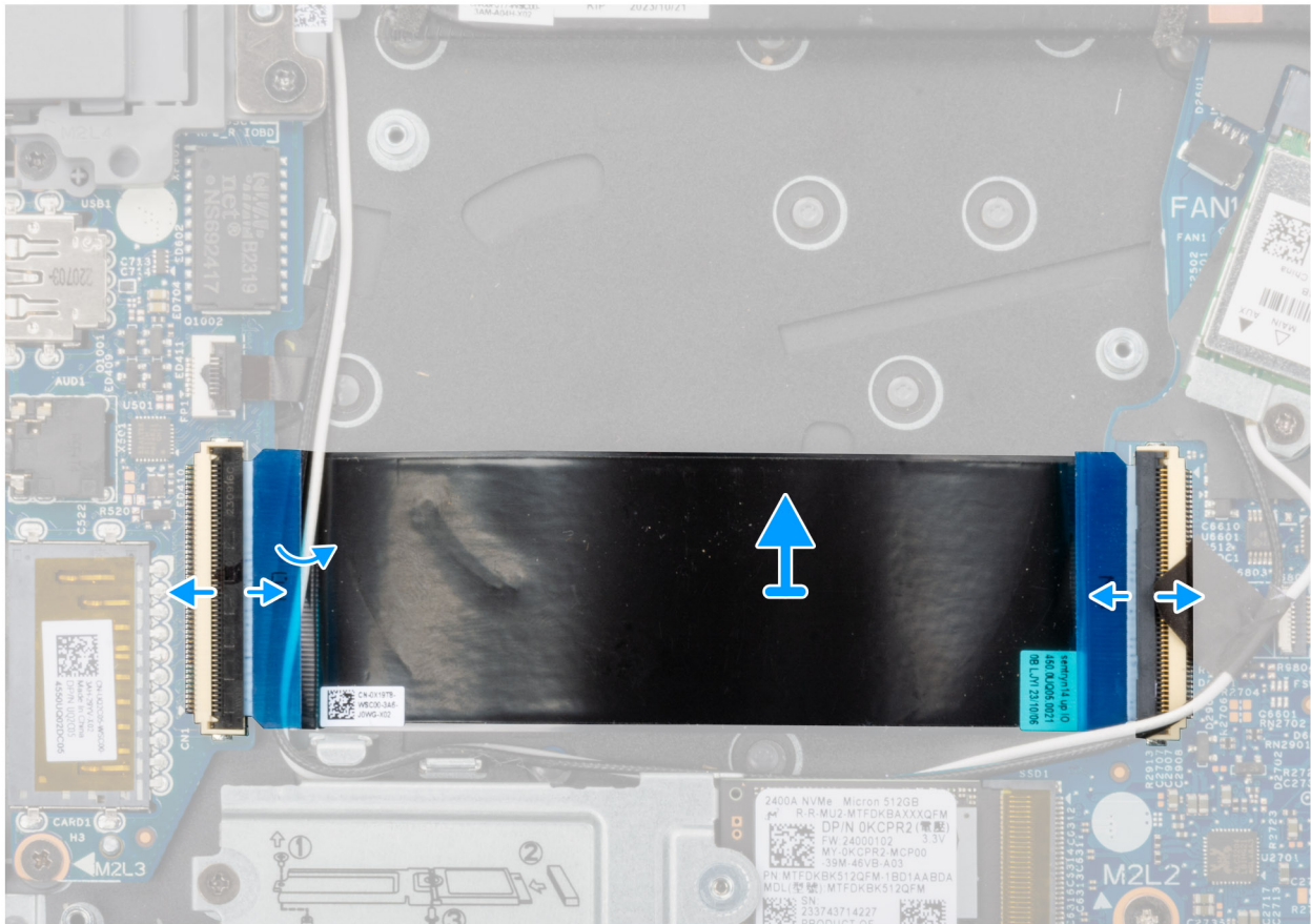
Obrázok 34. Demontáž kábla vstupno-výstupnej dosky
