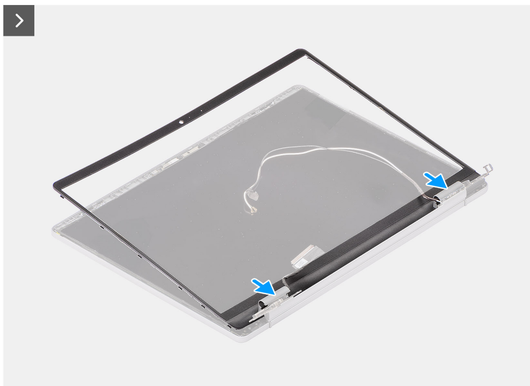
Obrázok 51. Montáž rámu obrazovky
