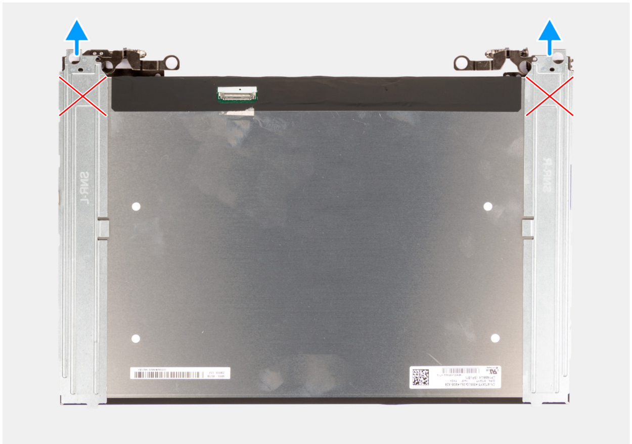
Obrázok 57. Demontáž zobrazovacieho panela
