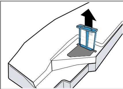
3. Vyčistite filter pod teplou tečúcou
