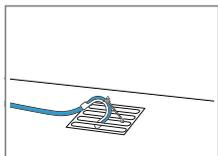
Odtokovú hadicu vody úplne zasuňte cez oblúk → *Strana 12* a zafixujte ju pomocou upevňovacieho materiálu. Oblúk upevnite na vpusť.
