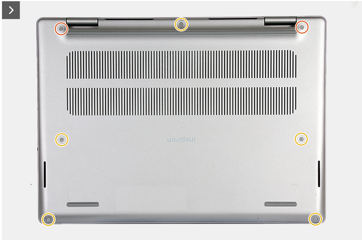
Obrázok 9. Demontáž spodného krytu
