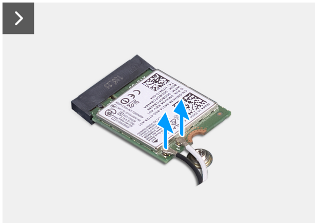
Obrázok 19. Demontáž karty bezdrôtovej komunikácie
