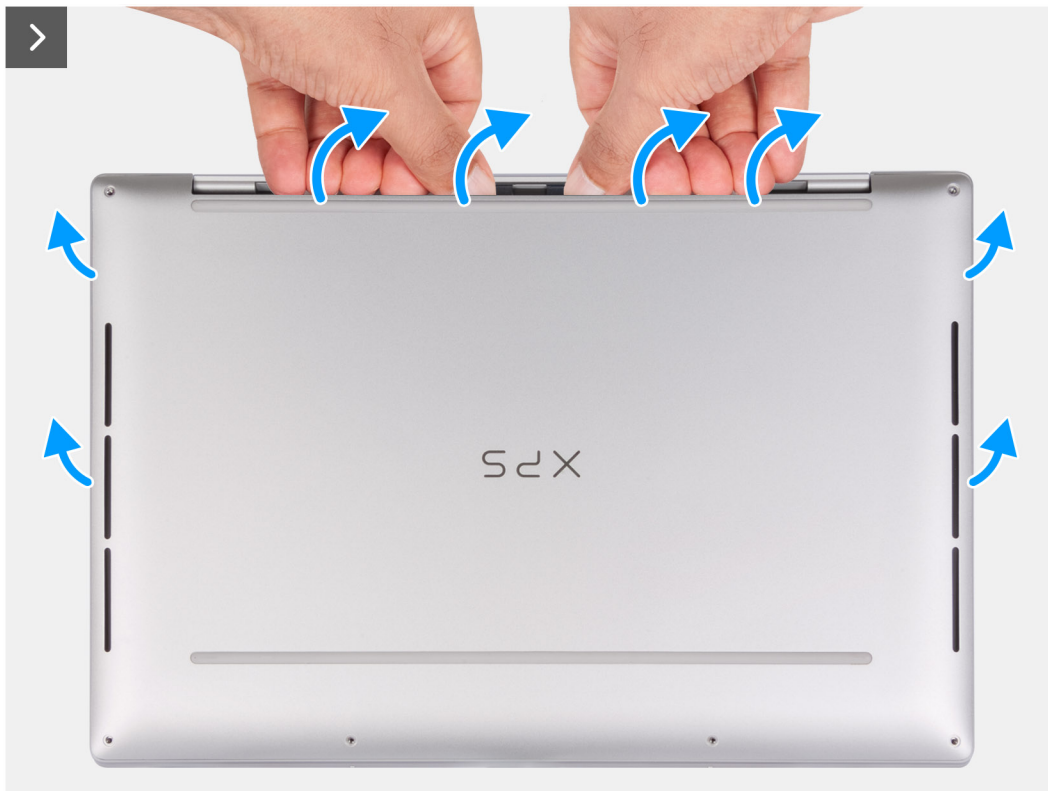
Obrázok 14. Demontáž spodného krytu
