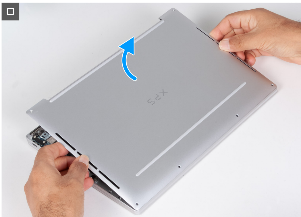
Obrázok 15. Demontáž spodného krytu
