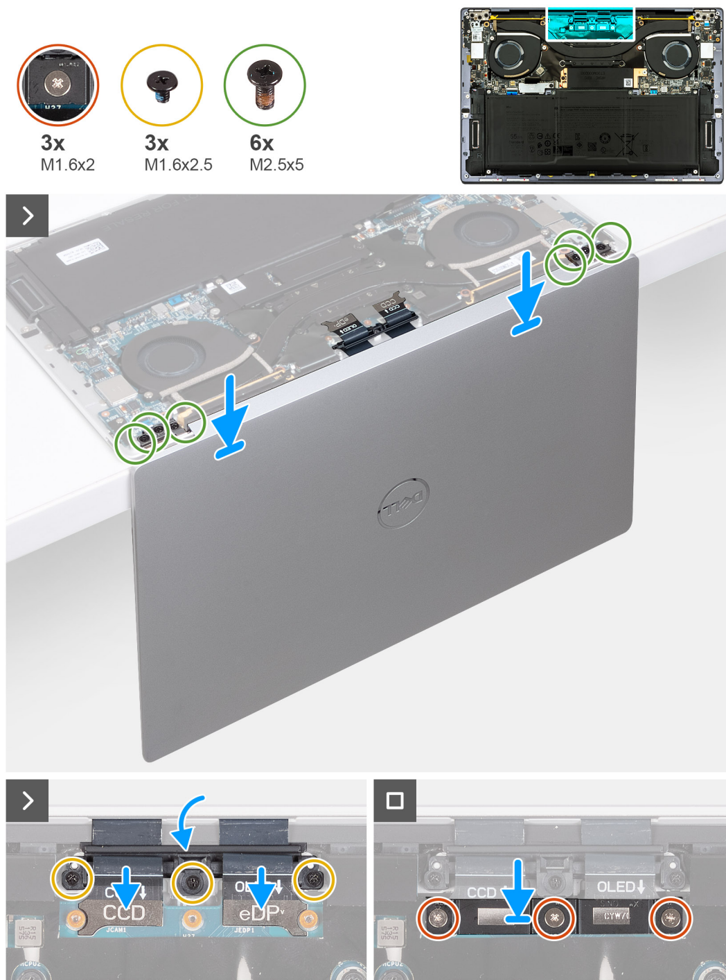
Obrázok 35. Montáž zostavy obrazovky
