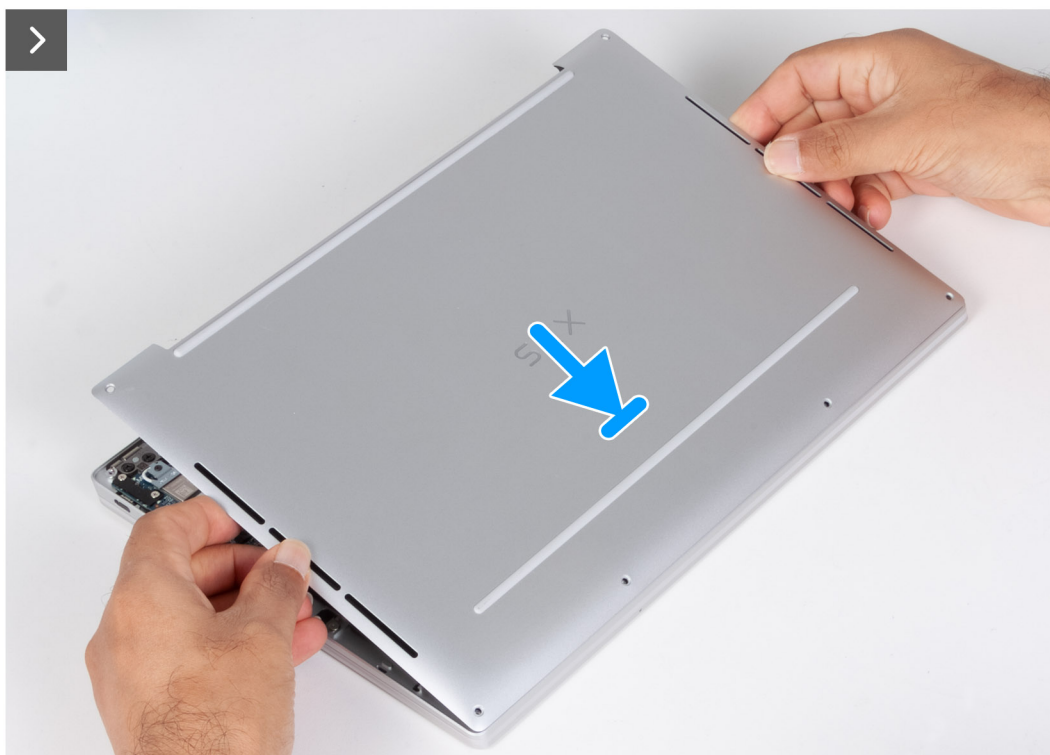
Obrázok 16. Montáž spodného krytu
