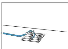
Odtokovú hadovicu vody úplne zasuňte cez oblúk → *Strana 12* a zafixujte ju pomocou upevňovacieho materiálu. Oblúk upevnite na vpusť.
