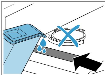
Pravidelne kontrolujte filter nádržky na vodu a znečistený filter vyčistite.
