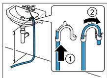
Odtokovú hadovicu vody úplne zasuňte cez oblúk → *Strana 12* a zafixujte ju pomocou upevňovacieho materiálu. Oblúk upevnite vo výške maximálne 100 cm.
