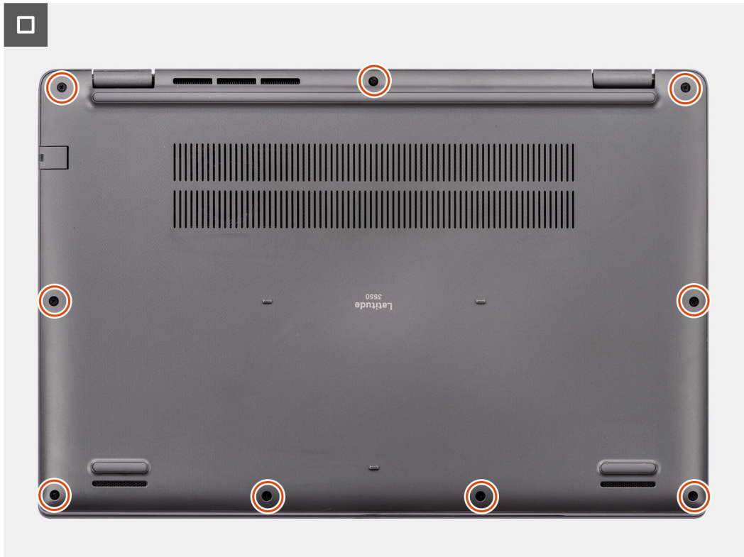
Obrázok 11. Montáž spodného krytu
