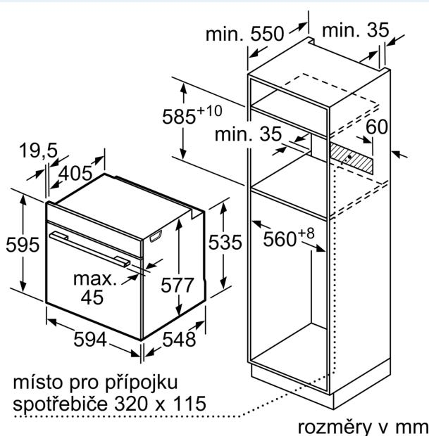
Pokud je spotřebič vestavěný pod varnou desku, musí být dodržená následující tloušťka pracovní desky (příp. včetně nosné konstrukce).
