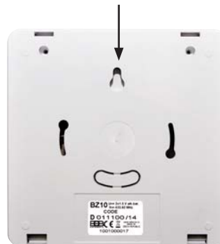
Obr.11 Umístěte na vhodné místo zavěšením
