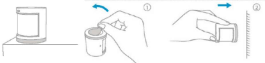
3. Wysokość instalacji powinna wynosić od 1,2 do 2,1 metra. Zakres wykrywania wynosi 150 stopni. W przypadku zainstalowania poniżej 1,2 m, zakres wykrywania ulegnie zmniejszeniu; w przypadku wysokości powyżej 2,1 m, zakres wykrywania może mieć martwe punkty.
