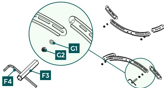
Namontujte dodané adaptéry VESA vždy vľavo a vpravo na ramená VESA pomocou podložiek [G1], skrutiek [G2], ako aj nástrčného [F3] a inbusového klúča [F4].
