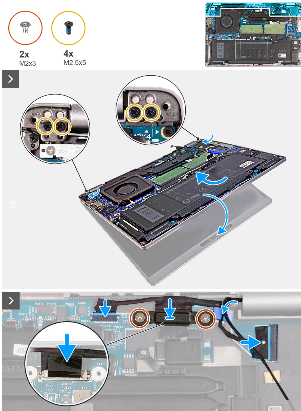
Obrázok 52. Montáž zostavy obrazovky – počítače dodávané so samostatnou grafickou kartou
