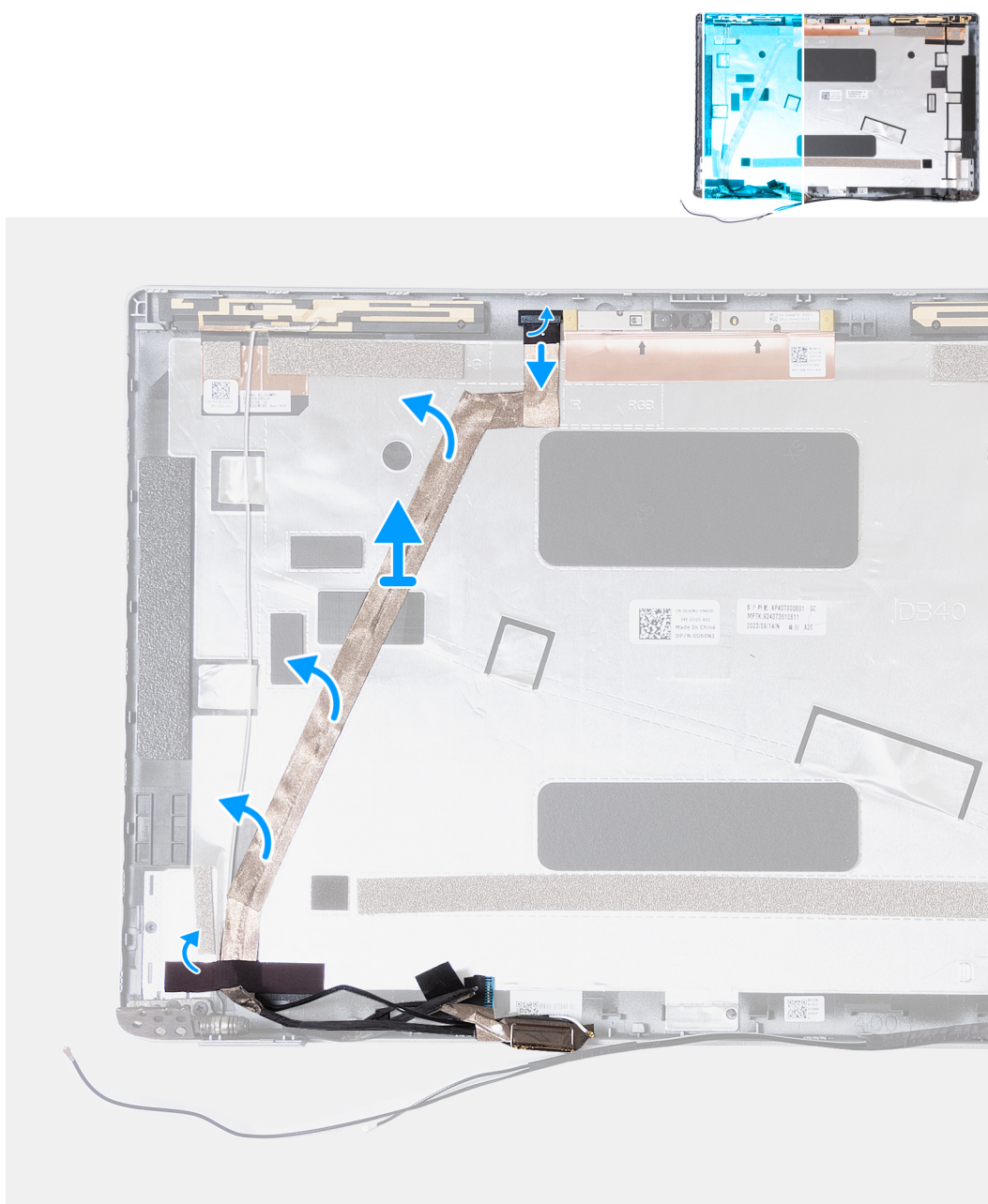
Obrázok 62. Demontáž video kábla
