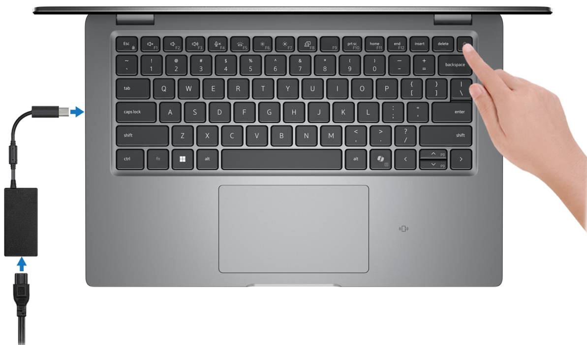
Obrázok 1. Pripojenie napájacieho adaptéra a stlačenie tlačidla napájania
