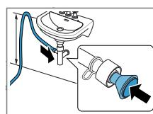
Miesto pripojenia zaistite hadicovou objímkou (12 – 22 mm). Odtokovú hadicu vody upevnite pomocou vedenia hadice vo výške minimálne 80 cm a maximálne 100 cm.
