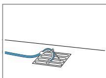
Odtokovú hadicu vody úplne zasuňte cez a zafixujte ju pomocou upevňovacieho materiálu. Oblúk upevnite na vpust.
