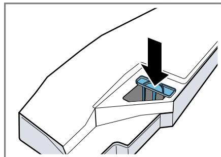
3. Vyčistite filter pod teplou tečúcou vodu alebo v umývačke riadu.
