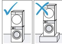
Tento spotrebič umiestnite v zostave práčka – sušička iba pomocou originálnej spojovacej súpravy od výrobcu sušičky.
