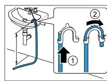
Odtokovú hadicu vody úplne za-suňte cez a zafixujte ju pomocou upevňovacieho materiálu. Oblúk upevnite vo výške maxi-málne 100 cm.
